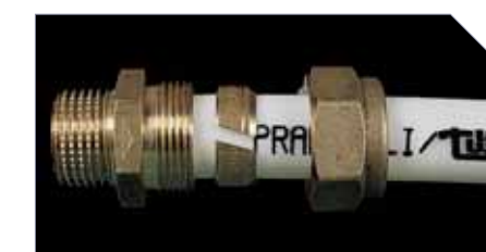
Ogiva montata ERRONEAMENTE
